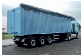
EISEL Hartstahlmulde 60m 3 ; Leergewicht 7.500 kg
