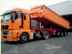
2-Seiten-Kippsattel mit pneumatischer Schütte
