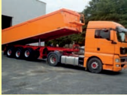
2-Seiten-Kippsattel mit pneumatischer Schütte
