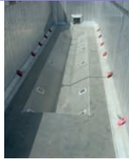
Coilmulde, 50m 3 mit Zurrmöglichkeiten; Leergewicht 6.600 kg
