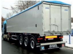
Coilmulde, 50m 3 mit Zurrmöglichkeiten; Leergewicht 6.600 kg
